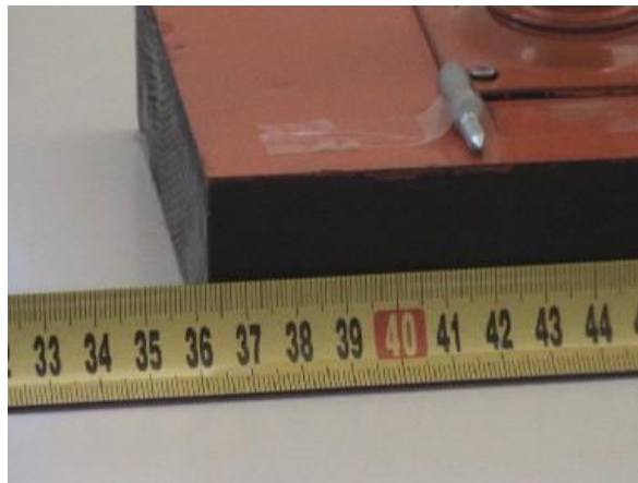
Slika 2: Marker, ki je pritrdjen na podstavek »predmeta« in predstavlja lego led diod.
